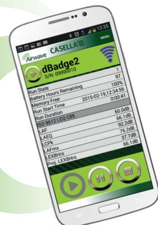
Start, stop e monitoraggio del dosimetro da remoto via smartphone iOS o Android
